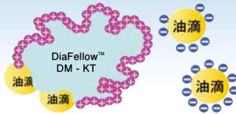
1. 負に帯電している微小油滴を吸着除去
